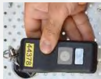
Dispositivo che legge Transponder LF
